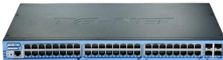
图表 1-4 S5100-52G-4TF 交换机前面板示意图
