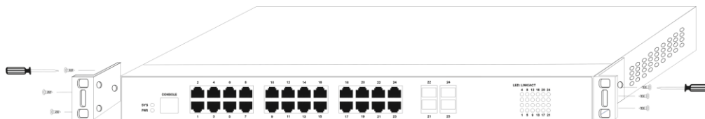
图表 3-1 交换机机箱支架固定图
